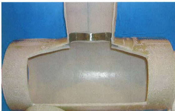
▲本管と取付管の一体更生
